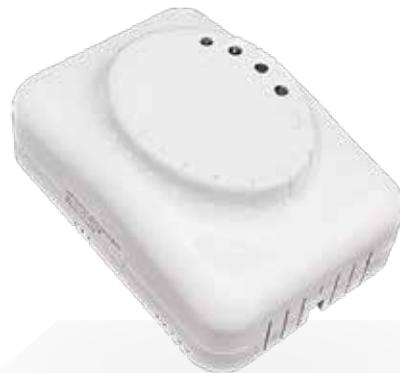
GS221 adreslenebilir gaz dedektörü, gaz sızıntılarını algılamak, ona göre alarm oluşturmak ve bu bilgiyi kontrol paneline iletmek için tasarlanmıştır. GS221 adreslenebilir gaz dedektörü, tüm Redban kontrol panelleri ile çalışabilir. Alevlenebilir ve yanıcı her türlü gazı algılayabilir. Cihaz, doğalgaz (metan), tüp gazı (propan), LPG (Sıvılaştırılmış petrol gazı), CNG (doğalgaz) gibi gazları algılar.
